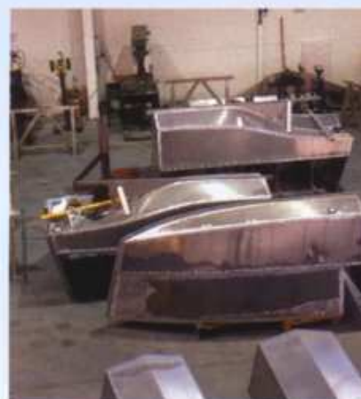
Zachodnie houseboaty są najczęściej jednokadłubowe i wykonane z laminatu. Tu mamy katamaran i konstrukcję z aluminium.
