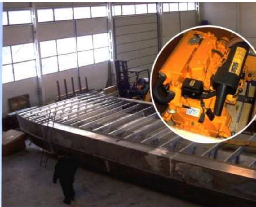
„Surowe” kadłuby. Nowiutki „dieselek” - jeden z dwóch, które napędzać będą dom na wodzie.
